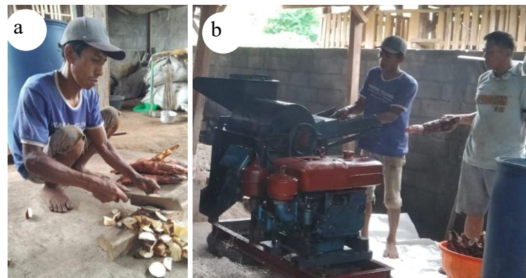
Gambar 3 Proses Pencacahan Singkong Menggunakan (a) Metode Manual (b) Metode Mesin
