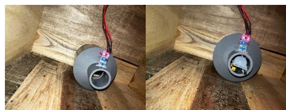
Gambar 9. Pengujian Sensor IR Obstacle
