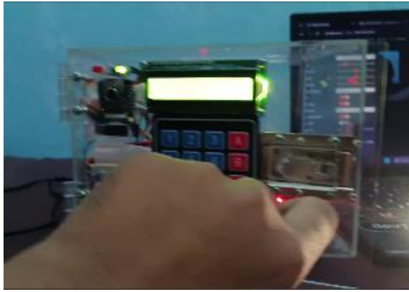
Gambar 19. Led merah mati dan led hijau menyala, pada saat pengenalan wajah berhasil
