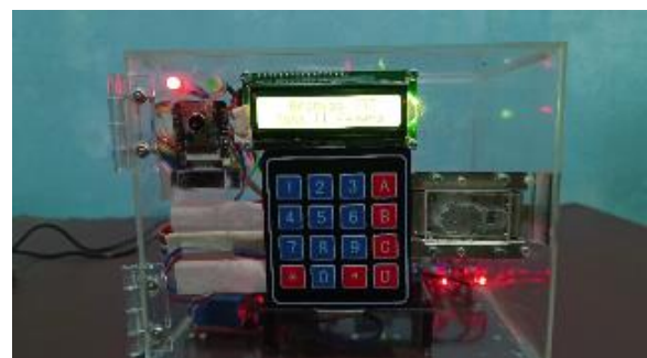
Gambar 18. Led merah menyala dan led hijau mati, pada saat mulai
