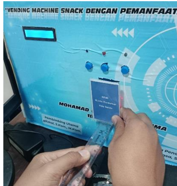
Gambar 10. Pengujian jarak baca RFID menggunakan penggaris
