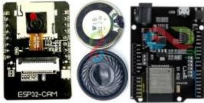
Gambar 2. Perangkat microcontroller (ESP32-CAM, Module Speaker, Wemos D1 R32)
