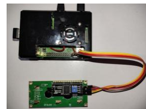
Gambar 7. Koneksi lcd display ke raspberry pi
