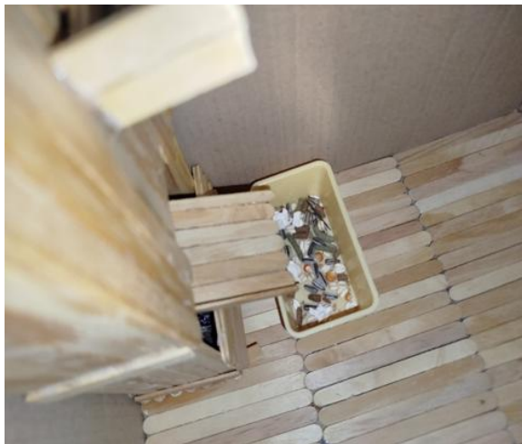
Gambar 7. Kondisi wadah pakan setelah servo selesai bergerak dan pakan berhasil diberikan
