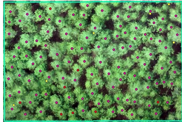
Gambar 7. Area sampel 3: deteksi pohon yang valid (titik ungu), tidak terdeteksi (titik merah), dan terdeteksi berlebihan (titik kuning).
