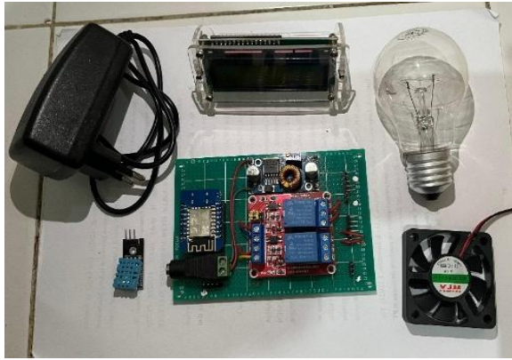
Gambar 2. Rangkaian instalasi kontrol suhu otomatis
