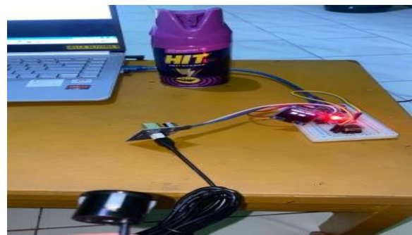
Gambar 3. Pengguna Mengarahkan Alat ke Objek untuk Mengukur Jarak
