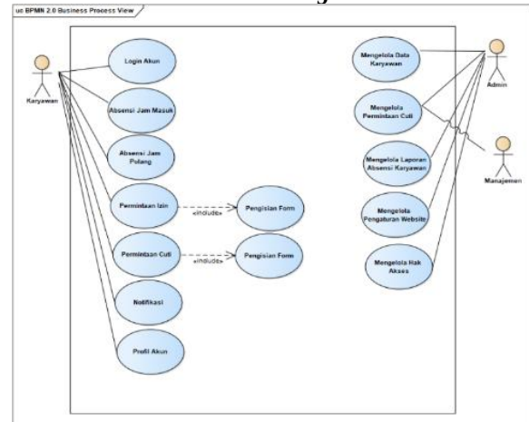
Gambar 3. Pemodelan Use Case Diagram
