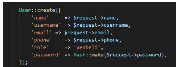
Gambar 13. Implementasi hash password menggunakan bcrypt
