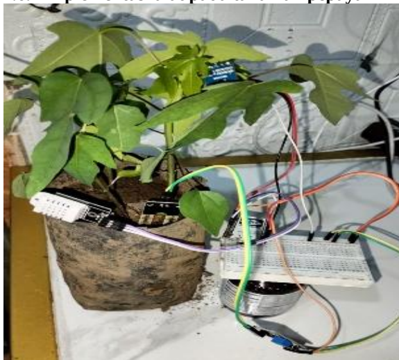
Gambar 13. Implementasi alat pada tanaman pepaya
