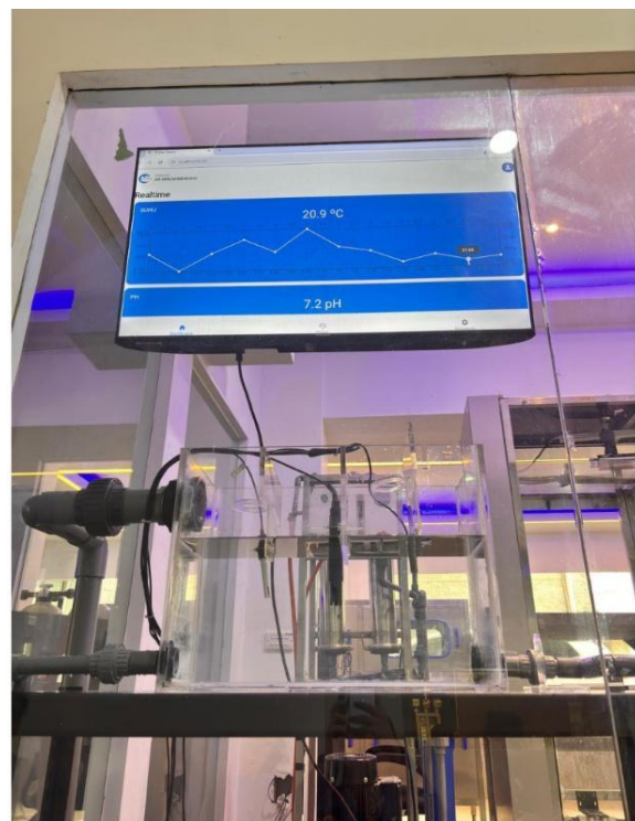
Gambar 4. Foto alat sensor suhu, pH, dan TDS
