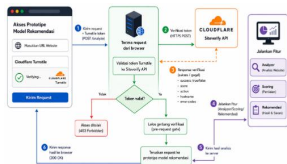
Gambar 5. Alur peran Turnstile sebagai gerbang verifikasi prototype model rekomendasi
