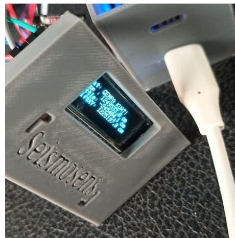
Gambar 17. Alat mendeteksi getaran level gempa kuat
