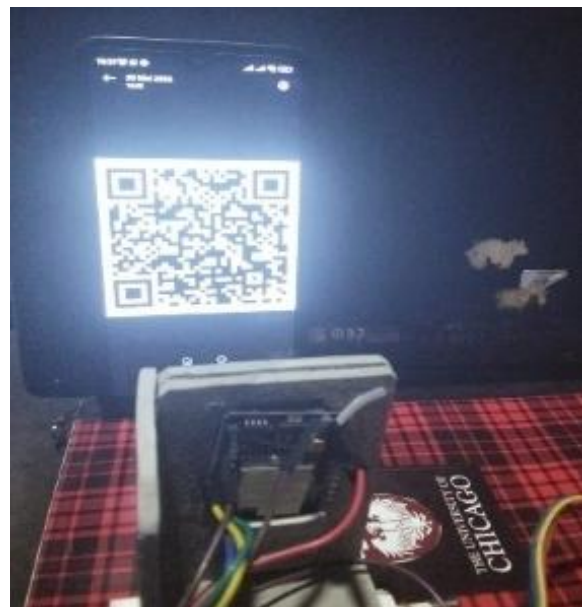
Gambar 4. Proses Pemindaian QR Code Menggunakan ESP32
