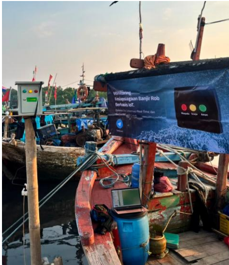
Gambar 5. Implementasi alat monitoring ketinggian air di lokasi penelitian
