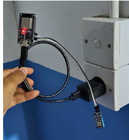
Gambar 3. Implementasi Perangkat IoT Sistem Monitoring Suhu dan Kelembapan
