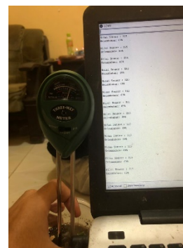
Gambar 22. Pengujian Threeway Meter dengan sensor output
