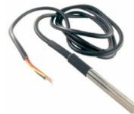
Gambar 3. Sensor DS18B20 Sumber: (Dokumen Pribadi, 2024)
