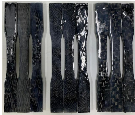
Gambar spesimen Uji Tarik (dari kanan: spread tow , hexagon , T300 )
