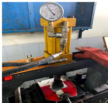
Gambar 6 proses pengepressan benda uji
