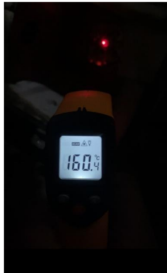
Gambar 6 suhu elemen pemanas 4000 rpm
