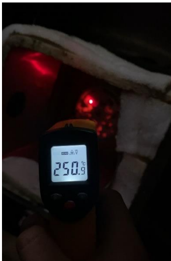
Gambar 5 suhu elemen pemanas 2000 rpm
