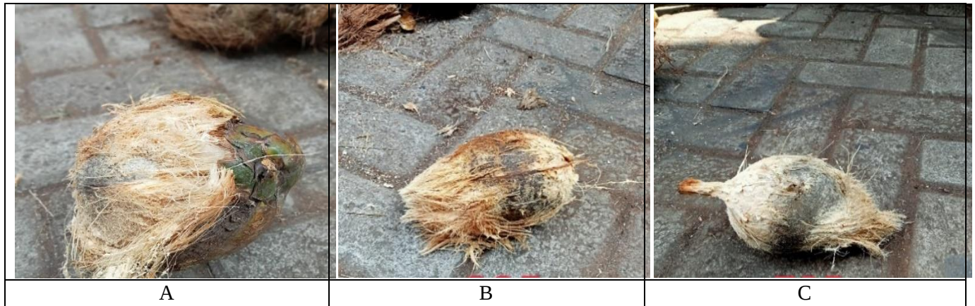
Gambar 4. (A).Hasil Pengujian Rpm 685.(B).Hasil Pengujian RPM 785.(C).Hasil Pengujian RPM 885
