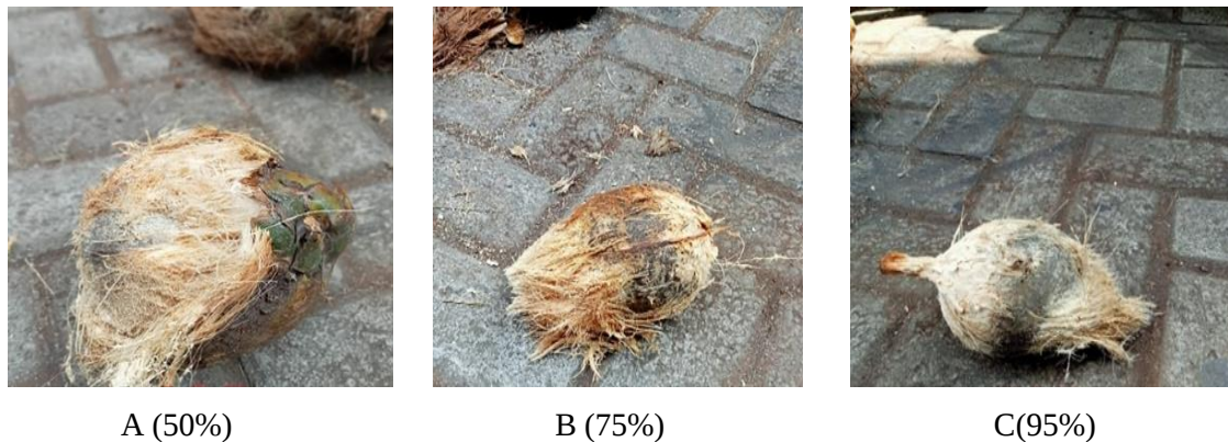
Gambar 4. (A).Hasil Pengujian Rpm 685.(B).Hasil Pengujian RPM 785.(C).Hasil Pengujian RPM 885 Sumber : Rainerius T. Rabin,2024
