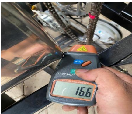
Gambar 5 Kecepatan yang di hasilkan gear 10:43
