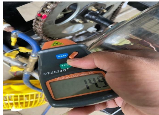
Gambar 4 Kecepatan yang di hasilkan gear 10:60
