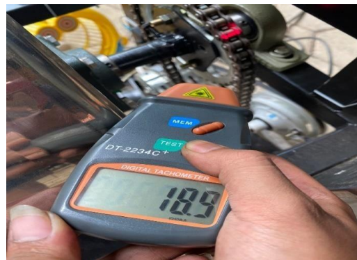
Gambar 6 Kecepatan yang di hasilkan gear 10:36
