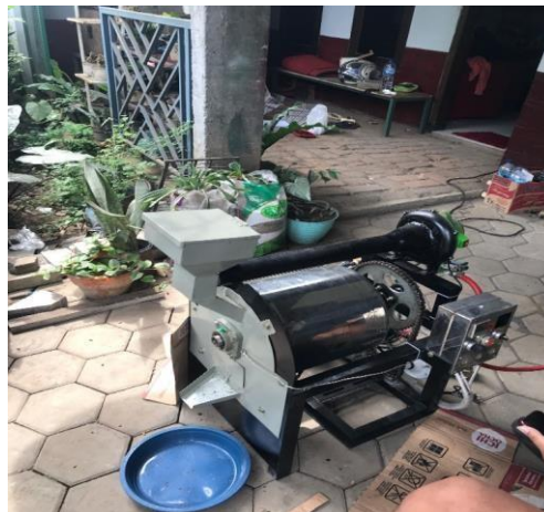
Gambar 1 Mesin roasting kopi tipe drum tangensial
