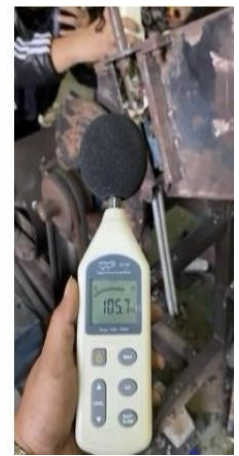
Gambar 2 Hasil Uji Kebisingan dengan Kecepatan 768.1 Rpm
