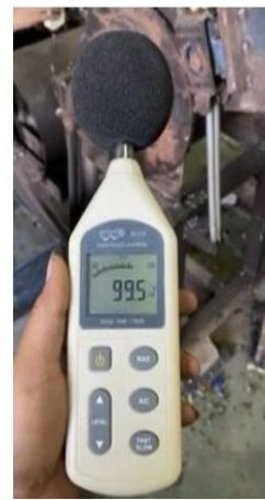
Gambar 2 Hasil Uji Kebisingan dengan Kecepatan 768.1 Rpm
