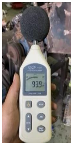
Gambar 2 Hasil Uji Kebisingan dengan Kecepatan 768.1 Rpm
