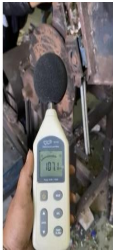
Gambar 1 Hasil Uji Kebisingan dengan Kecepatan 1.548 Rpm
