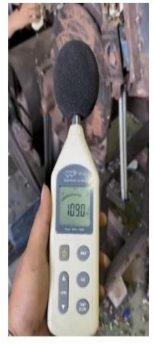
Gambar 2 Hasil Uji Kebisingan dengan Kecepatan 1.553 Rpm
