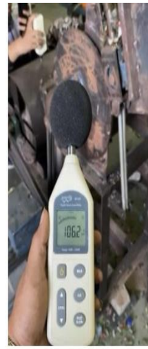
Gambar 2 Hasil Uji Kebisingan dengan Kecepatan 1.553 Rpm
