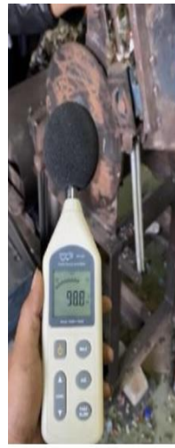
Gambar 2 Hasil Uji Kebisingan dengan Kecepatan 1.553 Rpm
