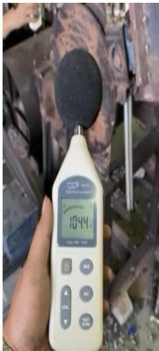
Gambar 1 Hasil Uji Kebisingan dengan Kecepatan 1.548 Rpm
