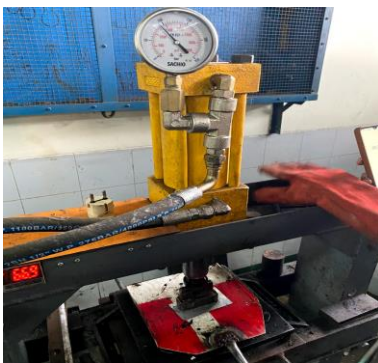
Gambar 6 proses pengepressan benda uji
