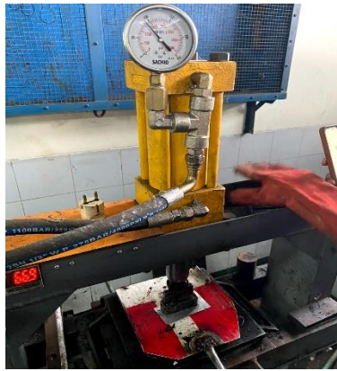
Gambar 6 proses pengepressan benda uji
