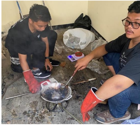
Gambar 5 proses pencampuran serat alam dan plastik PET
