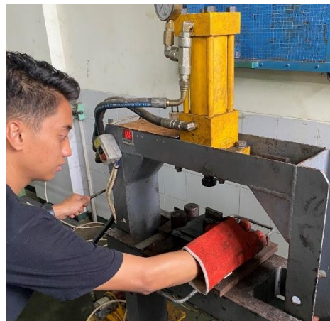
Gambar 6 proses pengepresan ecobrik
