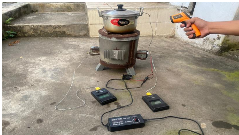
Gambar 1 Proses Uji Kompor Briket
