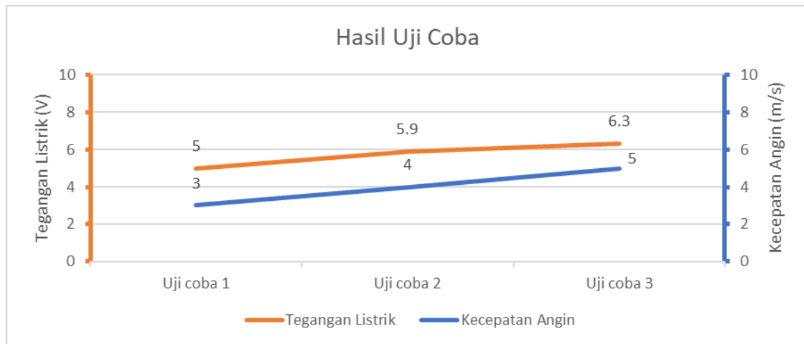
Gambar 1 Hasil Uji Coba Antara Kecepatan Angin dan Tegangan Listrik
