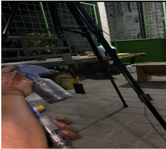
Gambar 2. Proses pengecatan pada permukaan spesimen
