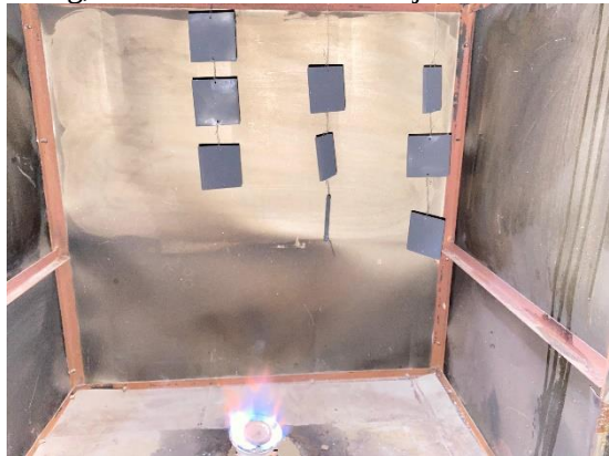
Gambar 3. Proses pengovenan spesimen
