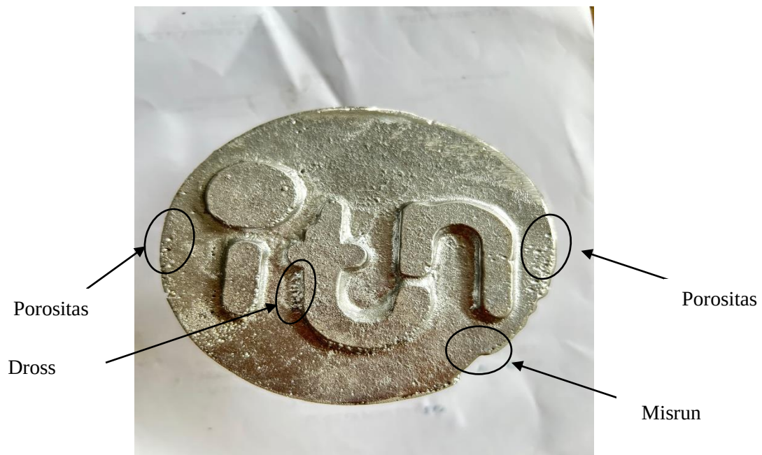
Gambar 5. Hasil Pengujian alat bantu pengecoran logam dengan metode rotary dengan RPM 100
