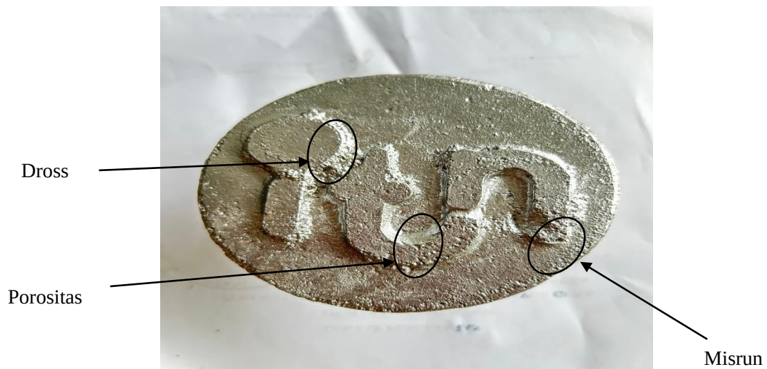
Gambar 6. Hasil pengujian alat bantu pengecoran logam dengan metode rotary dengan RPM 150
