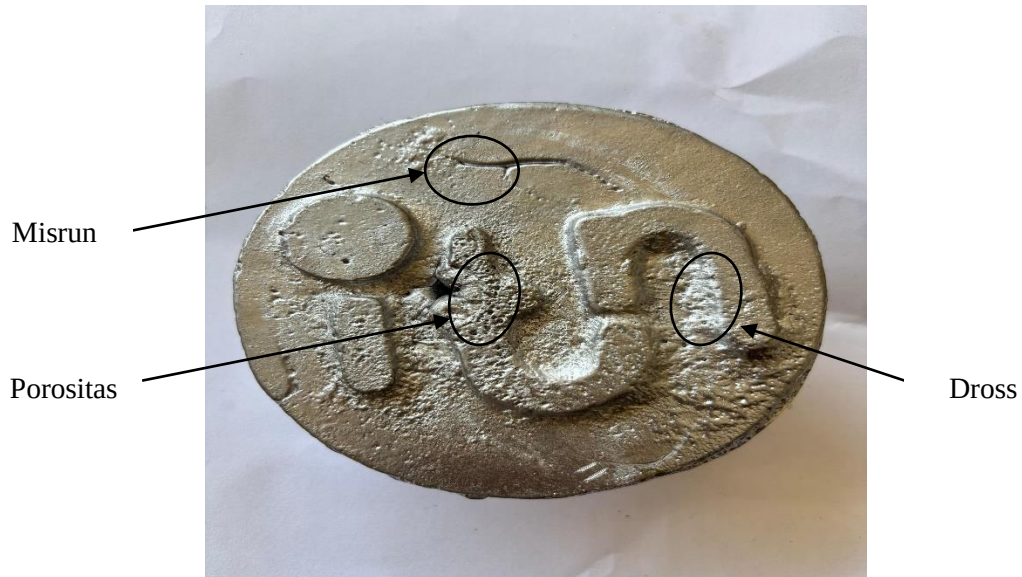
Gambar 4. Hasil pengujian pengecoran logam konvensional
