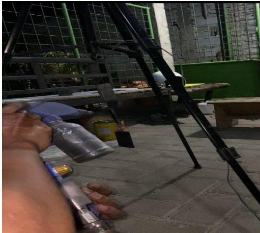
Gambar 2. Proses pengecatan pada permukaan spesimen
