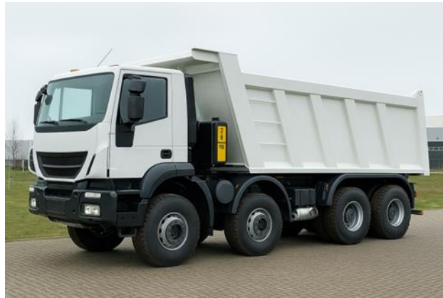
Gambar 1 Truk tambang tipe 8×4 yang digunakan dalam penelitian.
