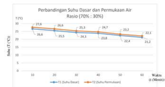
Gambar 4. Grafik perbandingan suhu dasar dan permukaan air rasio 70%:30%
