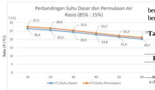
Gambar 3. Grafik perbandingan suhu dasar dan permukaan air rasio 85%:15%
