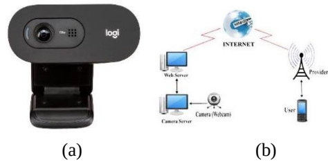
Gambar 12. (a) Webcam, (b) Cara kerja webcam
