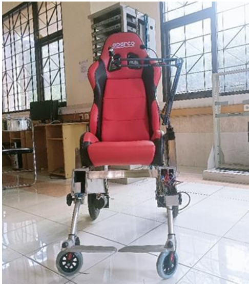
Gambar 21..Desain Alat Kursi Roda Elektrik
