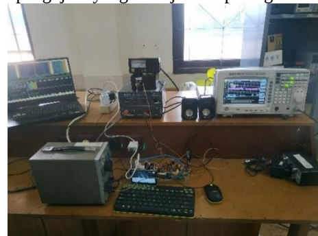
Gambar 27 Konfigurasi Perangkat Transceiver SDR dan Tranverter
