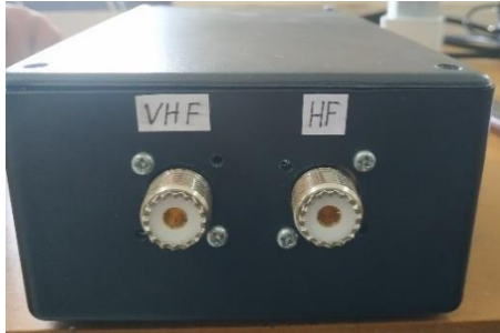
Gambar 23 Bagian Output Transverter
