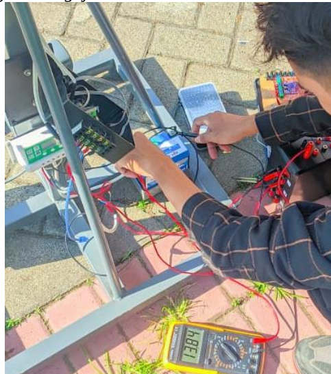
Gambar 19. Pengukuran tracking panel surya
