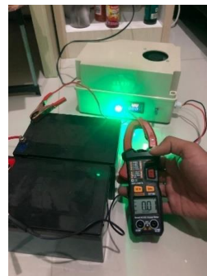
Gambar 14. proses pengujian dengan mode slow charge
