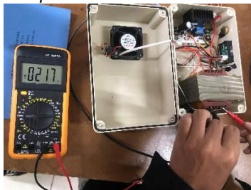
Gambar 11. pengujian arus yang masuk ke trafo
