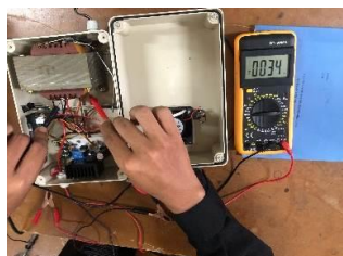
Gambar 12. pengujian arus yang keluar dari trafo menggunakan Avometer
