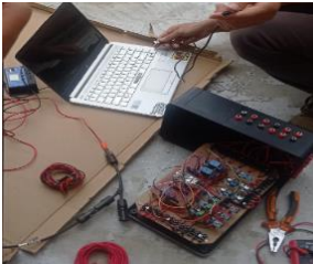
Gambar 24. Proses Menghubungkan Thingspeak dengan ESP32
