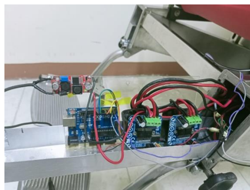
Gambar 14. Arduino uno pada kursi roda
