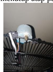
Gambar 9. Pengujian Sistem Mototr Stepper Untuk Sistem Atap Otomatis Kandang Burung
