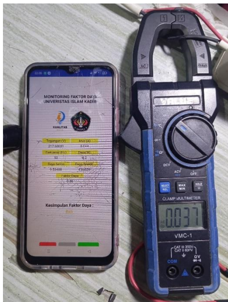
Gambar 24. Pengujian Arus pada aplikasi dan alat ukur
