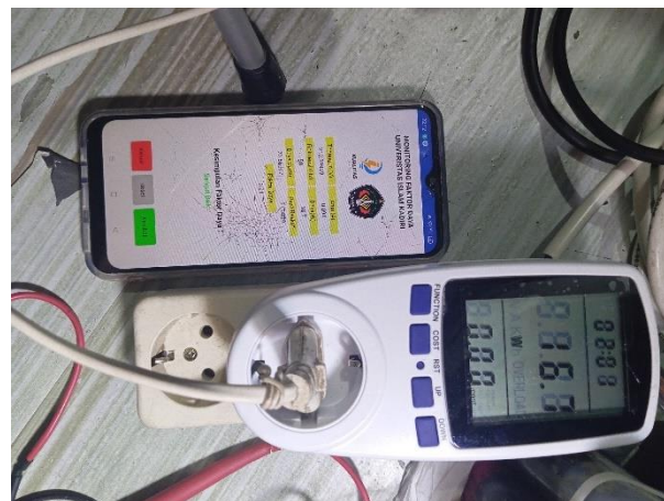
Gambar 25. Pengujian Daya pada aplikasi dan alat ukur
