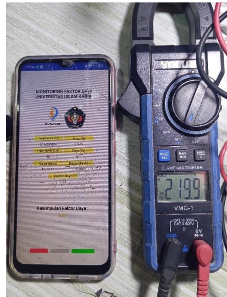
Gambar 23. Pengujian Tegangan pada aplikasi dan alat ukur
