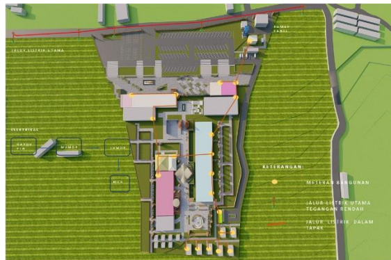
Gambar 15. Jaringan listrik Sumber : Analisa pribadi, 2023
