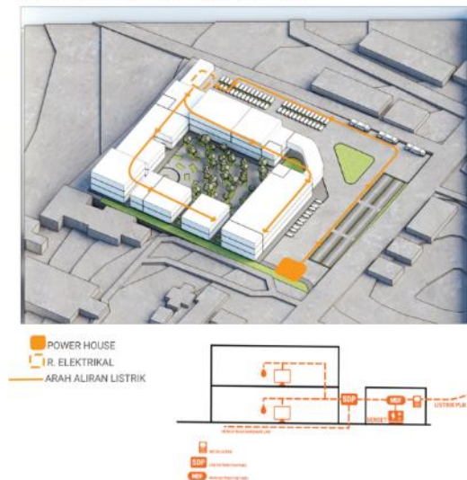
Gambar 15. Konsep Utilitas Jaringan Listrik
