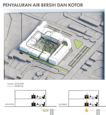
Gambar 14. Konsep Utilitas Air Bekas dan Air Kotor
